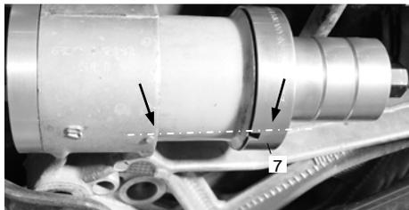
Fig. 7: Cambio del silent-bloc
